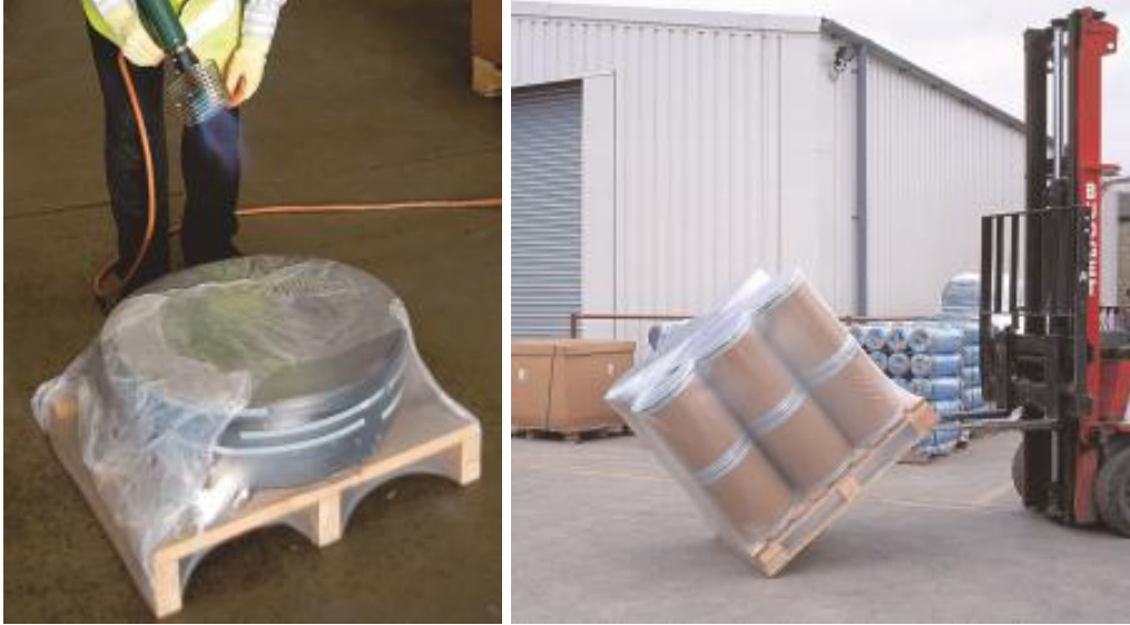
Şekil 5 – Polietilen palet kaplama uygulanaşı ve kaplamanın dayanıklılığı
