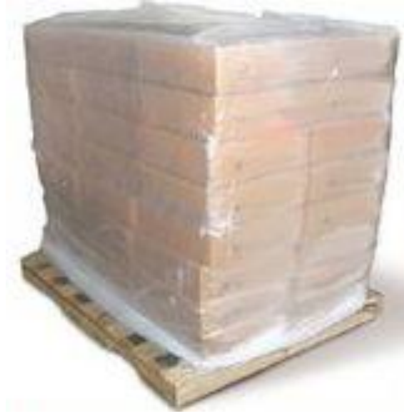
Şekil 4 – Polietilen palet kaplama uygulanmış palet
