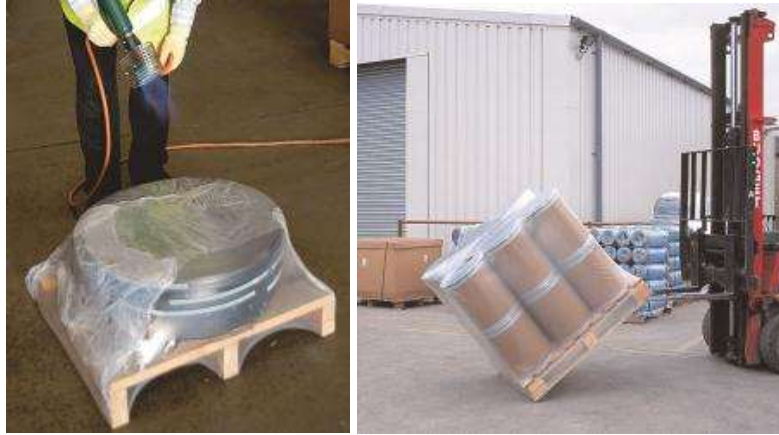
Şekil 5 – Polietilen palet kaplama uygulaması ve kaplamanın dayanıklılığı
