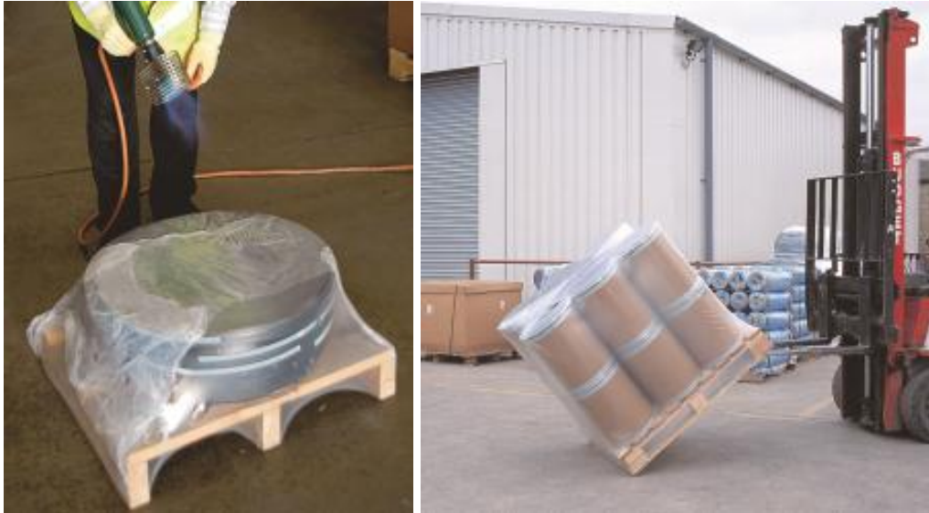
Şekil 5 – Polietilen palet kaplama uygulaması ve kaplamanın dayanıklılığı
